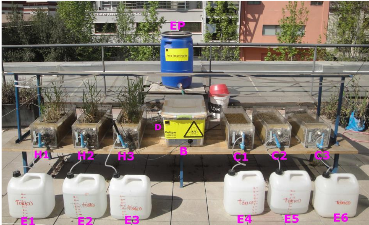
Figura 1: Instalación Experimental. H1, H2 y H3 corresponden a humedales plantados. C1, C2, y C3 son celdas de control sin plantas. Las celdas de acrílico tienen dimensiones de 60 x 20 x 15 cm (largo, ancho, altura de sustrato). El caudal es regulado con una bomba peristáltica. Se cuenta con un vertedero de PVC a la salida con el cual se puede regular la altura de agua.
